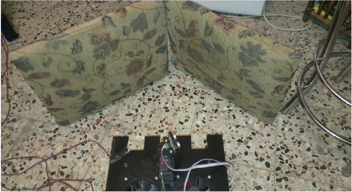
شکل ۴-۷ DSPR در حال پویش یک سطح تورفتگی
